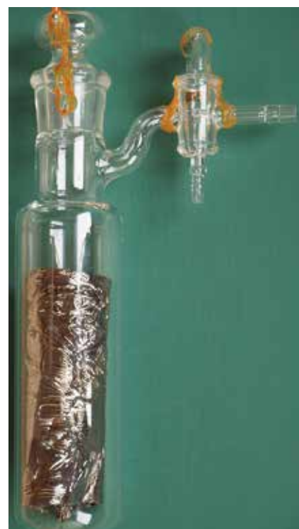
25年前に筑波大学の実験室で合成し、高純度アルゴンで封入したポリアセチレンのフィルム（白川氏所蔵）
